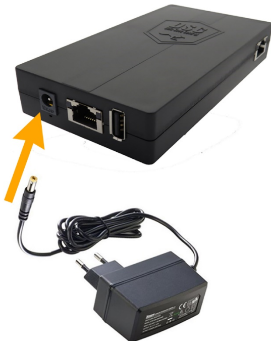
Abb. 10: Stromversorgung an DSC Lan anschließen
