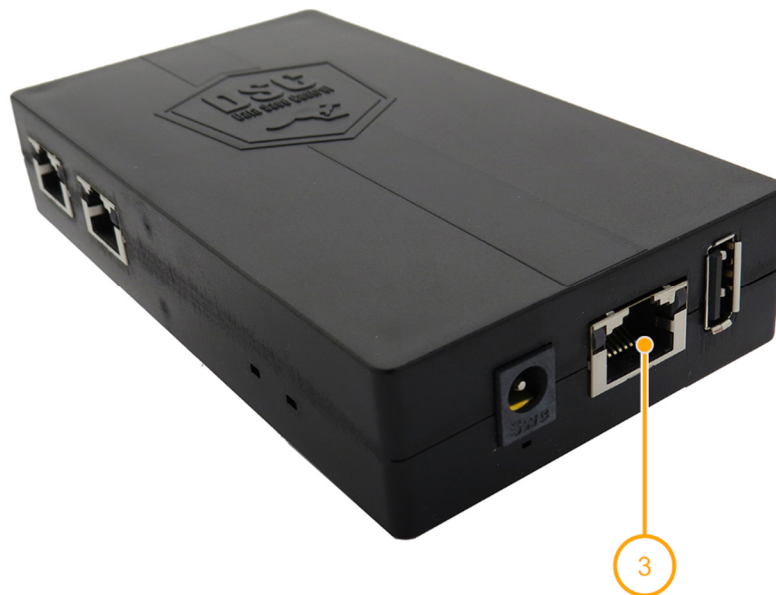
Abb. 11: DSC Lan mit PC verbinden
